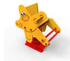
Se trata de muelle con forma de estrella de mar realizado en su totalidad con paneles de polietileno HDPE con filtro UVA antidecoloración de 15mm de espesor y en distintos colores. Las partes metálicas son tubos de acero inoxidable y un muelle metálico de Ø20mm con sistema antipinzamiento para sujeción del mismo a la placa de anclaje de 5mm galvanizada y pintada termolacado al horno.
